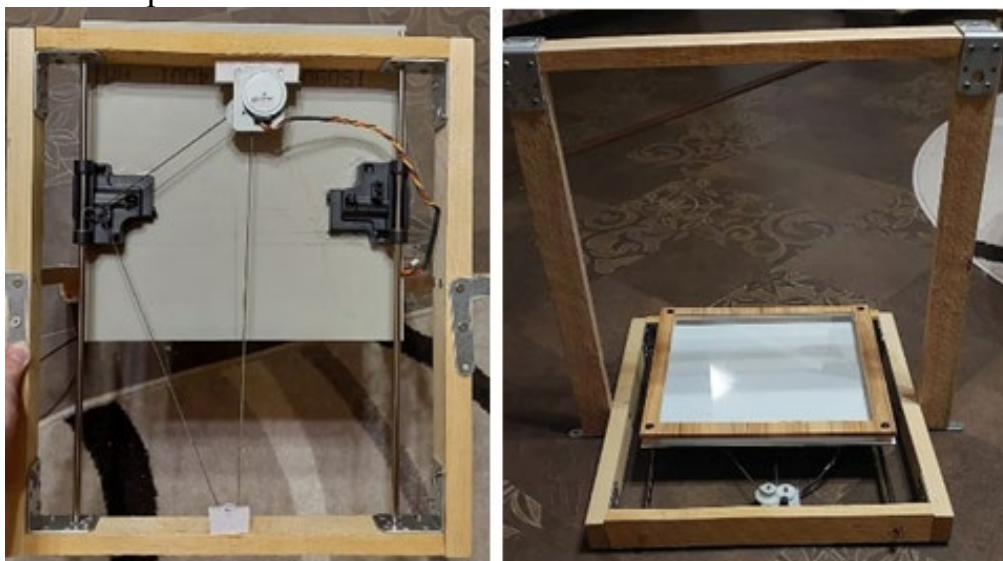
Рис. 4. Каркас и рабочий стол 3D-принтера
