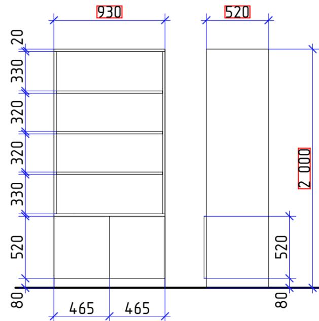
Схема габаритных размеров шкафа 1:30
