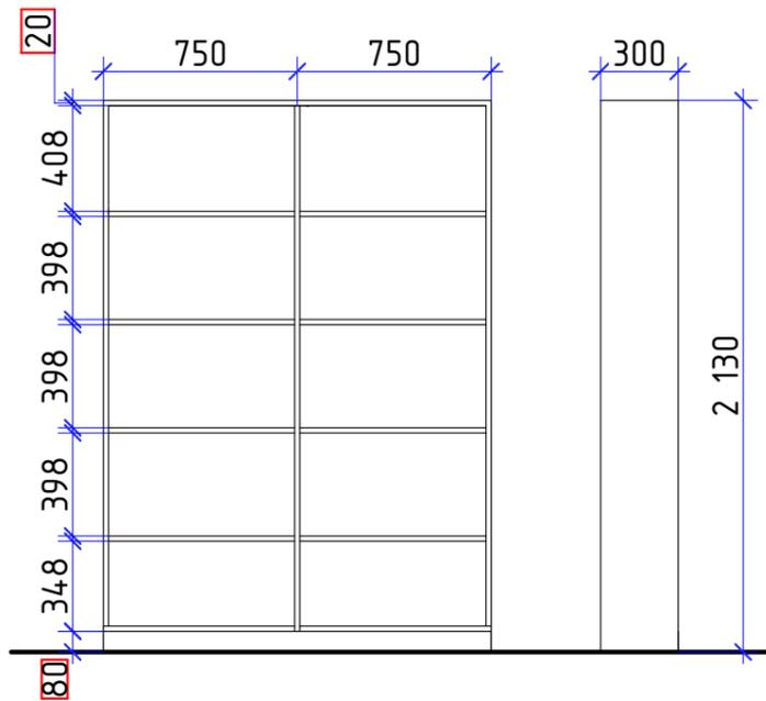
Схема габаритных размеров встроенных полок 1:30
