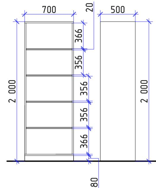
Схема габаритных размеров стойки администратора 1:30
