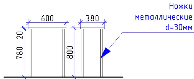
Схема габаритных размеров стола 800x800мм 1:30
